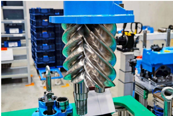
Teilmontierte Schraubenverdichter-Baugruppe, bestehend aus zwei Rotoren und dem blau lackierten Lagerdeckel. © MAPAL
