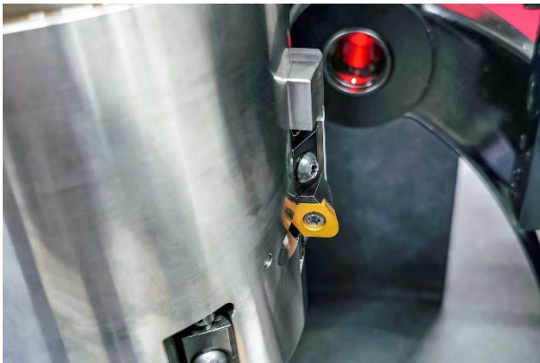
Bild 2: In bestimmten Bereichen des Aussteuerwerkzeugs kommen formgeschliffene Schneidplatten mit Sonderkontur zum Einsatz.
