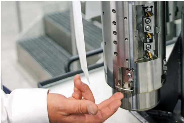
Bild 3: Die Rundlaufabweichung des Werkzeugs darf bei einer Länge von 380 mm nicht mehr als 3 \mu m betragen.
