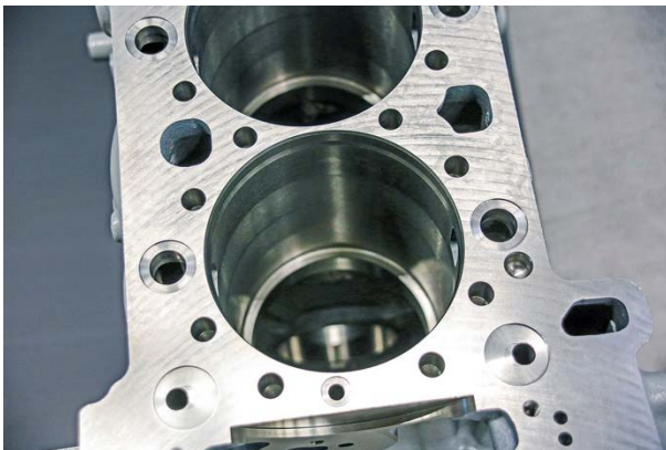
Bild 1: Bei der Bearbeitung der Aufnahmen für die Zylinderlaufbuchsen in LKW-Motorblöcken ist höchste Präzision gefordert.
