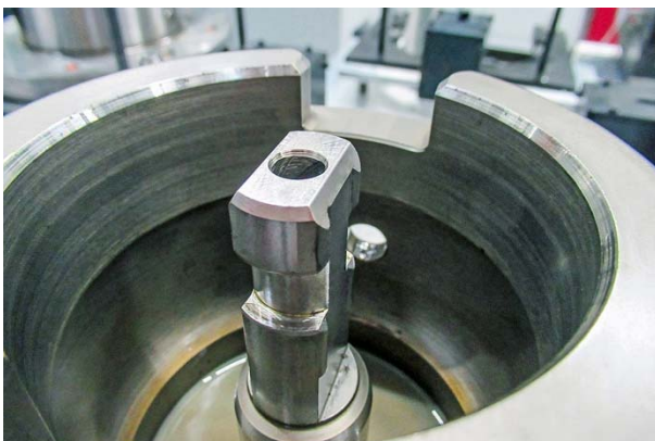
Bild 4: Die Betätigung der Schieber des Aussteuerwerkzeugs erfolgt über eine Zugstange mit hochpräziser Bajonettkupplung.
