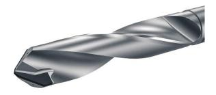
Mit seiner speziellen Schneidengeometrie ist der PKD-Bohrer ganz besonders für die Bearbeitung von CFRP-Materialien geeignet und vermeidet Delamination am Bauteil. (©MAPAL)
