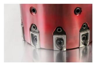
PKD-Planfräser von MAPAL zeigen überall dort ihr Potenzial, wo eng tolerierte Ebenheiten oder spezielle Oberflächentoleranzen im Mittelpunkt stehen, wie zum Beispiel in der Leiterplattenfertigung. (©MAPAL)
