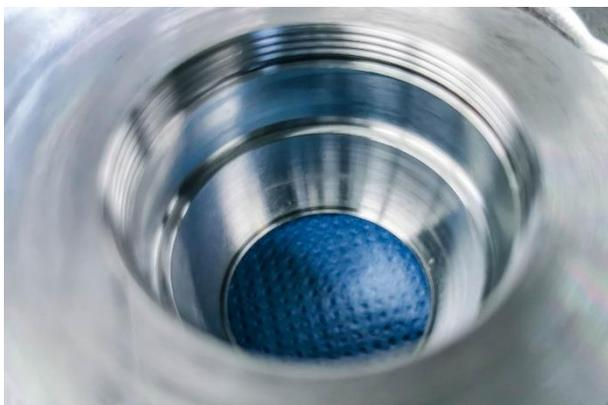
Bei der Bearbeitung des Domlagers sind enge Toleranzen bis zu  $\pm 5 \mu\text{m}$  einzuhalten. Extrem enge Toleranzvorgaben gelten auch für das Feingewinde.
