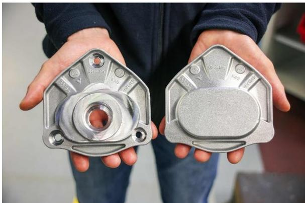
Domlager aus geschmiedetem Aluminium für die Anbindung des Gelenkkopfs des Federbeins einer Fahrzeugachse an die Karosserie.
