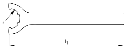
Chave de fixação para suporte para pinças de fixação conforme DIN 69882-6 e mandril rosqueado Softsynchro
