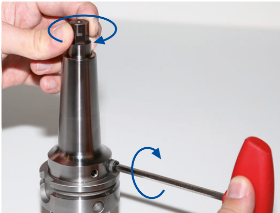
Figura 1: Girar parafuso de fixação e item de teste de ferramentas
