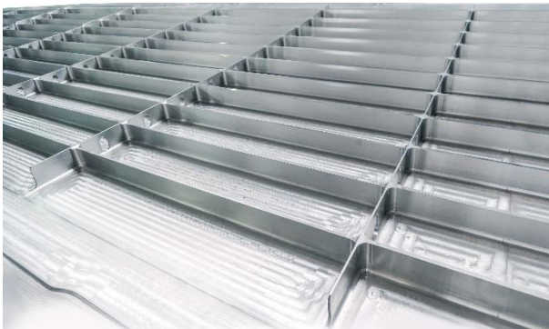
Bild 3: Die Innenform des Flügels aus Aluminium wird mit Werkzeugen von MAPAL bearbeitet.
