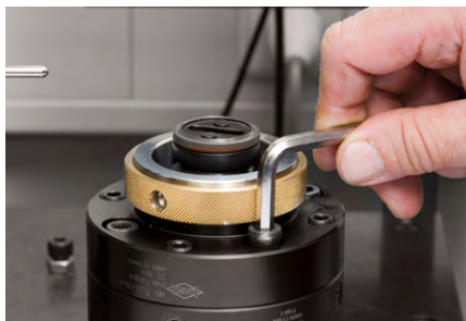
2. Vorsatzflansch einfügen. Befestigungsschrauben anlegen.
