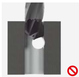
Perçage excentré ; Arête transversale pas en prise
