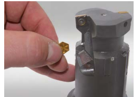
4. Sortir la plaquette de coupe de la cassette.
