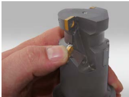
3. Appuyer la cassette et le vé de réglage vers l'avant, en direction de l'outil.
