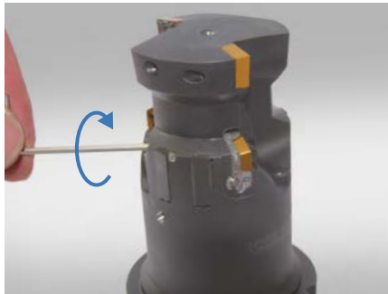
1. Desserrer le vé de réglage avec une clé Allen et tourner d'un demi-tour dans le sens antihoraire.
