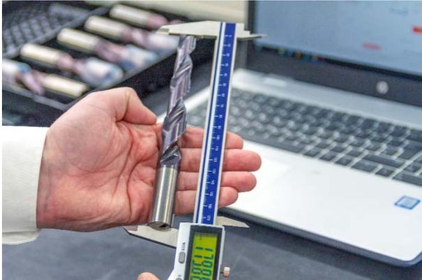
Bild 4: Per Knopfdruck werden Messergebnisse vom Bluetooth-Messschieber an c-Com übertragen.
