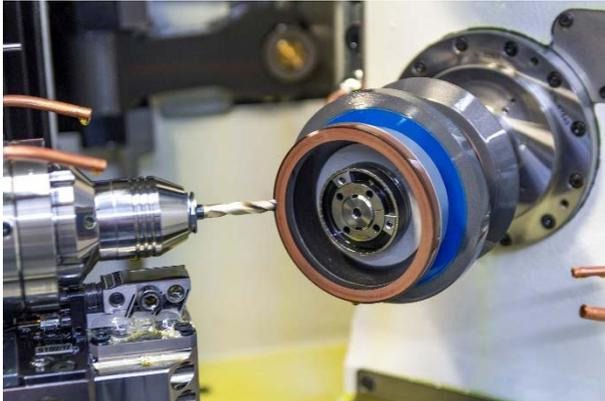
Bild 8: Rund 6.000 Werkzeuge werden wöchentlich bei MILLER in Originalqualität nachgeschliffen.
