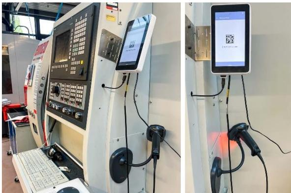
Zwei der EMCO Maschinen sind mit c-Connect Boxen ausgestattet, um Daten per Scan an die Maschine übertragen zu können. ©MAPAL
