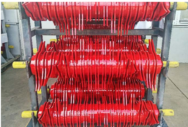
Bild 4: Etwa ein Dutzend unterschiedliche Walzen und Achsen sind für den Bau einer Rundballenpresse erforderlich. Dazu gehört der gezeigte Rotor mit aufgeschweißten Zacken, der für einen optimalen Transport des Strohs in der Presse sorgt.
