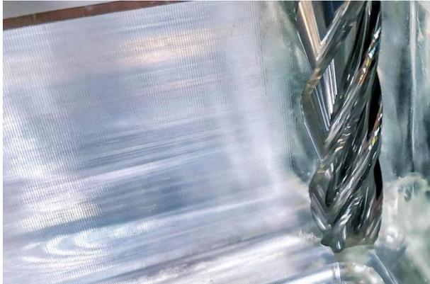
Dank seiner langen Schneiden kann der Schlichtfräser aus Vollhartmetall, der OptiMill-SPM-Finish, die Wände selbst tiefer Taschen in einem einzigen Zug bearbeiten.
