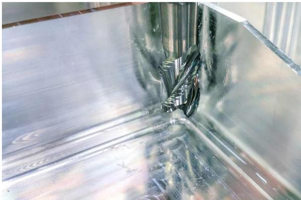
Der für die Hochleistungszerspanung entwickelte innengekühlte Vollhartmetallfräser OptiMill-SPM-Rough für das Schruppen hat einen konischen Hals für optimale Steifigkeit.
