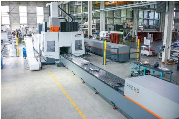
Die Fünf-Achs-Bearbeitungszentren der PBZ HD-Baureihe von bavius können Werkstücke mit Maßen von bis zu 30.000 x 800 x 575 mm bearbeiten. Die Spindeln (bis zu 80 kW/ 30.000 min<sup>-1</sup>/ 39 Nm) ermöglichen hohe Zerspanungsraten.
