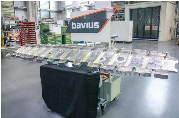
Diese Flügelrippe aus AL 7075 für ein Großraumflugzeug wiegt nach der Zerspanung bei Abmessungen von 3.600 x 600 x 100 mm gerade noch 30 kg von ursprünglich 600 kg. Die Wanddicken liegen zwischen 1,6 und 4 mm.
