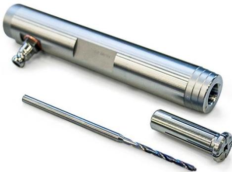
Im Detail: Das Sonder-Hydrodehnspannfutter, eine Reduzierhülse und ein damit zu spannendes Bohrwerkzeug; die Hydrodehnspannfutter eines Typs haben dieselben Dimensionen, es können Reduzierhülsen in Abstufungen von 1 mm eingesetzt werden. ©Schweizer Maschinenbau
