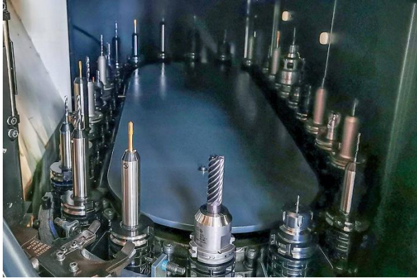
Blick in den Werkzeugspeicher eines der Fräsbearbeitungszentren.
